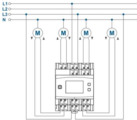
Anschluss der Rohrmotoren (Ausgänge)
