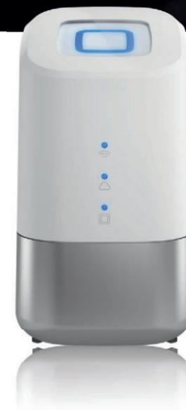
Der Homematic IP Access Point stellt das zentrale Gateway des Homematic IP Smart-Home-Systems dar. Er wird einfach an Ihren herkömmlichen Router angeschlossen und verbindet die in Deutschland befindliche Homematic IP Cloud mit den Homematic IP Geräten im eigenen Zuhause – und das vollständig verschlüsselt.
