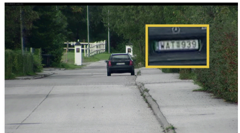
Die Weitwinkelansicht (links) und die herangezoomte Ansicht (rechts) mit einer HDTV 1080p PTZ-Kamera: Das Kennzeichen ist noch in einer Entfernung von 275 m lesbar.
