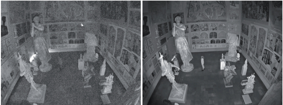
Links: Schnappschuss im Nacht-Modus ohne Infrarotstrahler (ein wenig Licht fiel durch eine Spalte unter einer Tür in der linken Ecke in den Raum ein). Rechts: Schnappschuss im Nacht-Modus mit Infrarotstrahlern.
