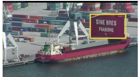
Die Weitwinkelansicht (links) und die herangezoomte Ansicht (rechts) mit einer HDTV 1080p PTZ-Kamera: Der Text auf dem Frachtschiff ist noch aus 1,6 km Entfernung lesbar.
