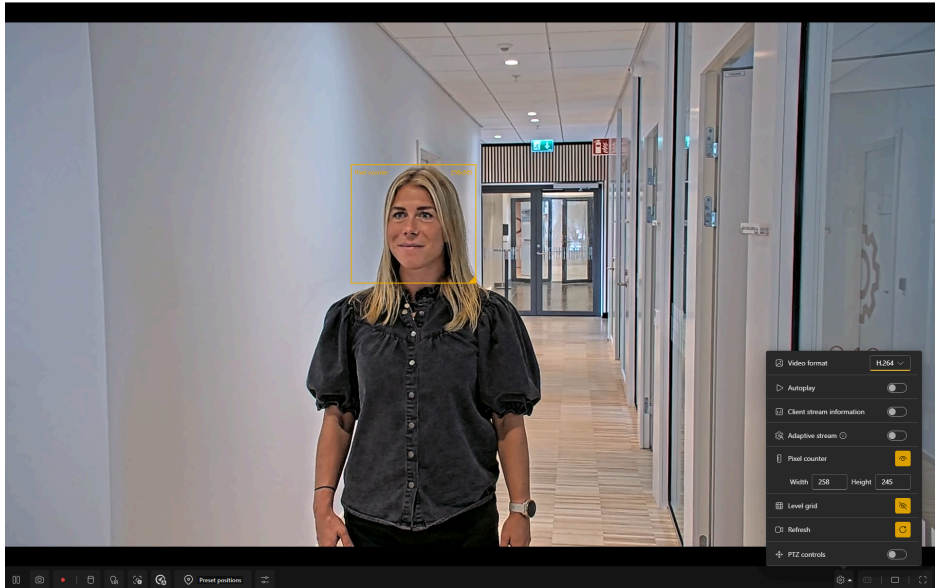
Axis Pixelzähler, der die Pixelauflösung einer Fläche anzeigt.
