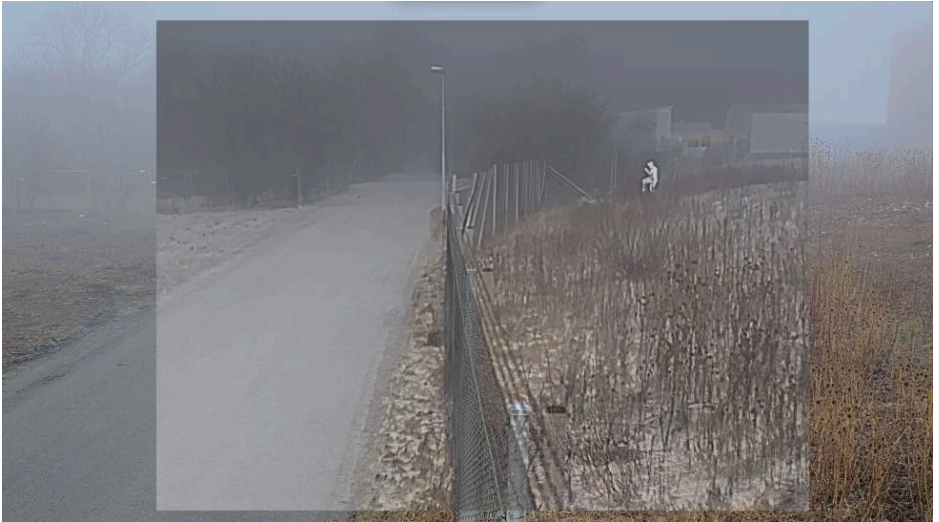
Zusammengeführtes Bild einer bispektralen Kamera mit Fusion von Wärmebild- und optischem Bild.
