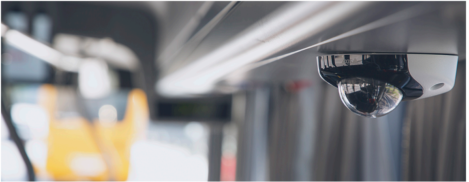
Eine Onboard-Dome-Kamera, die in der Decke eines Busses montiert ist.
