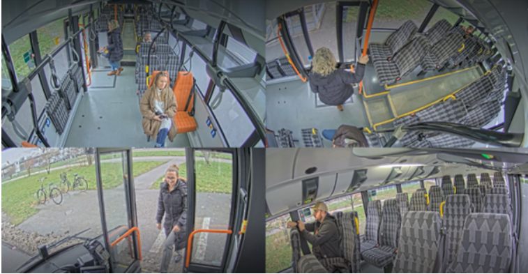
Videostream in der Vierfachansicht von einer in einem Bus installierten modularen Kamera mit vier Kanälen.
